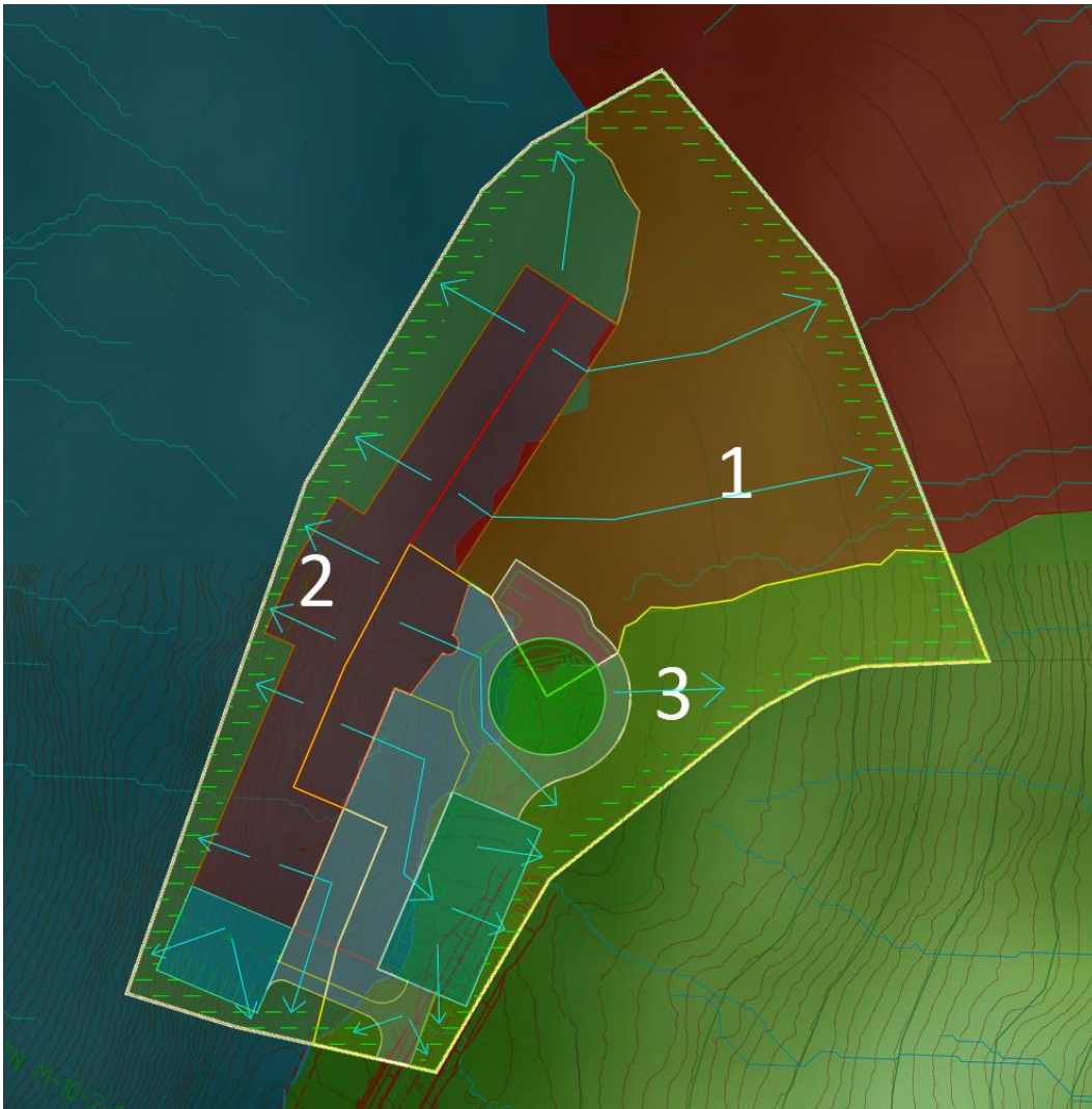
Figur 9. Illustration planerad höjdsättning utifrån befintliga avrinningsområden och placering av makadamdike.
